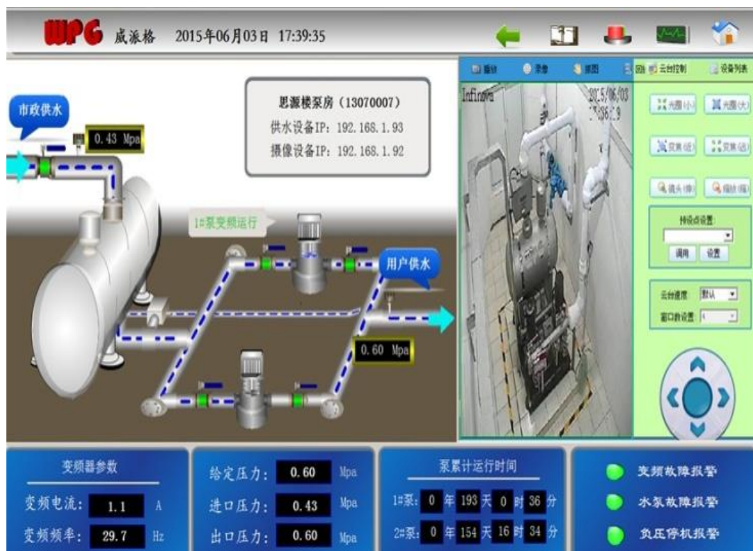
无负压供水系统
